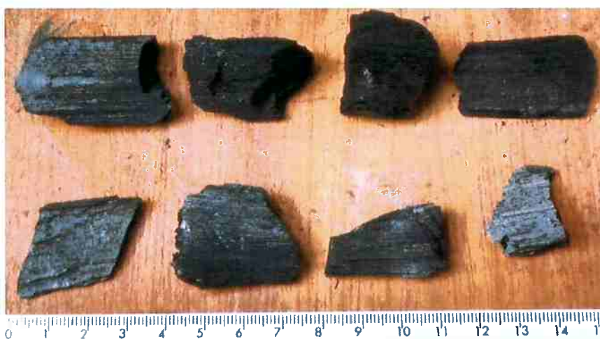
Figura 35 - Foto de oito amostras tipo B da Tabela 14 retiradas aleatoriamente da faixa de 22,2 após compressão e peneiramento.
