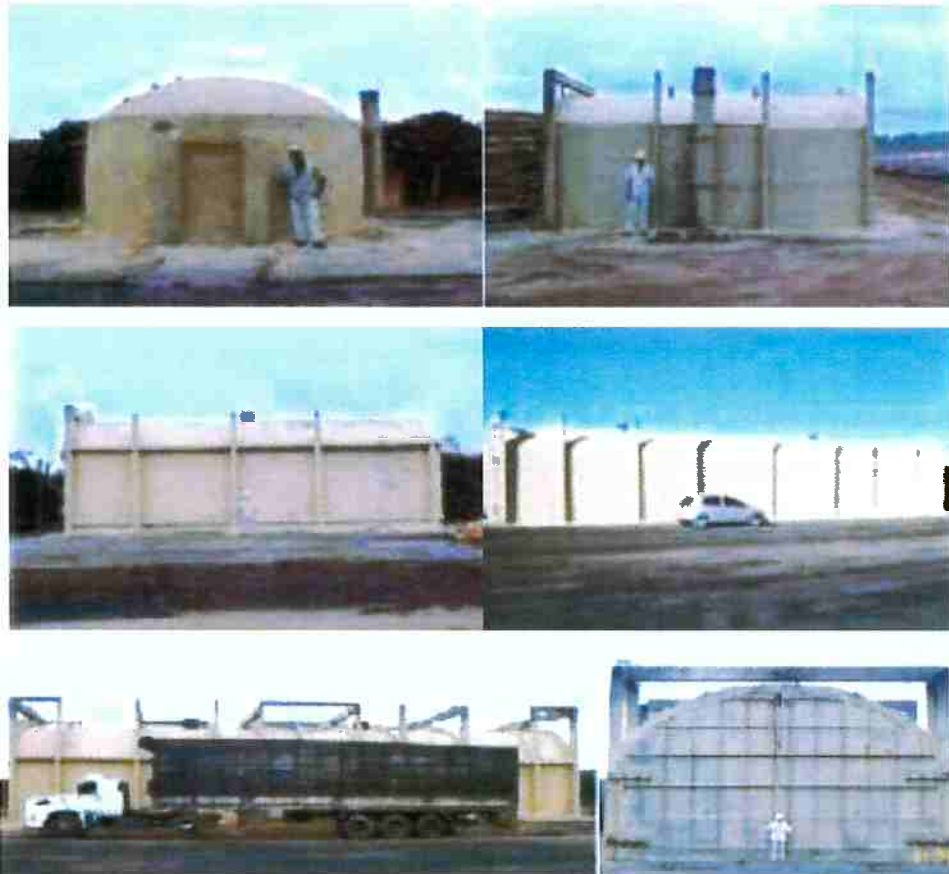
Figura 6 - Evolução dos fornos de carbonização, manual (cima esquerda), RAC 40 (cima direita), RAC 110 (meio esquerda), RAC 220 (meio direita), RAC 700 (baixo), da ArcelorMittal, extraído de (10).
