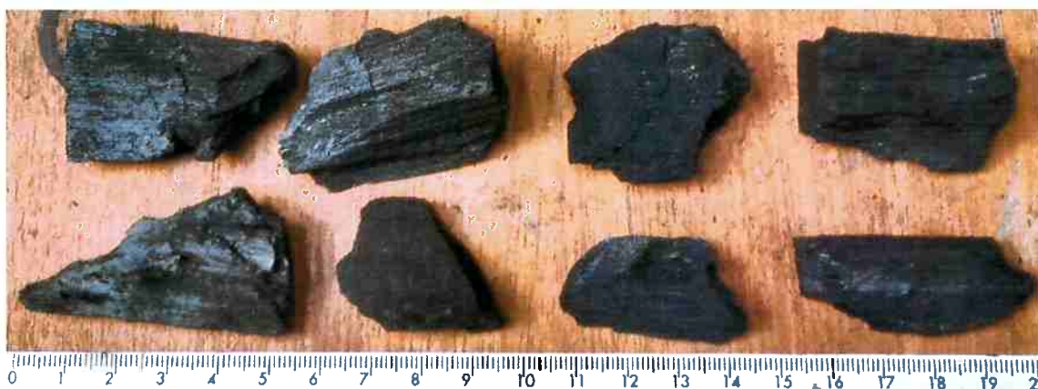
Figura 34 - Foto de oito amostras tipo A da Tabela 14 retiradas aleatoriamente da faixa de 25,4 após compressão e peneiramento.
